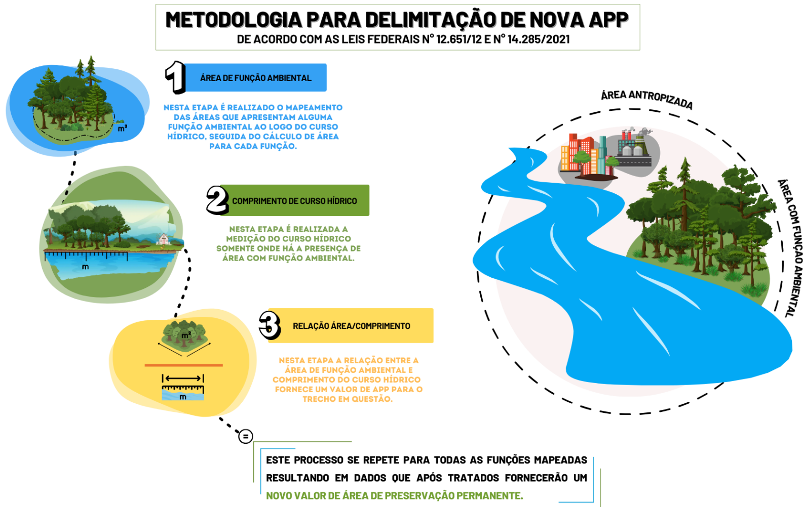
Figura 147 - Cartograma ilustrando a metodologia para delimitação da nova Área de Preservação Permanente - APP.
